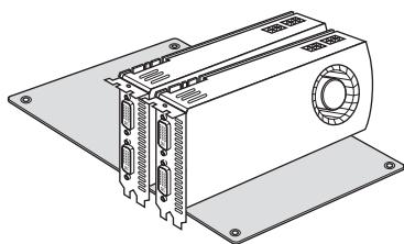
1 枚のグラフィックスカードを PCIe1 スロットに挿入し、もう 1 枚のグラフィックスカードを PCIe3 スロットに挿入します。 カードがスロットに正しく収まっていることを確認してください。
